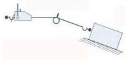
Richtungswechsel des Drahtseils
